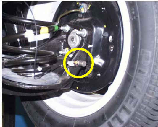
Foto 8 – Setup realizado em ensaio em campo – Medições de vibração da suspensão de um veículo – Destaque para o acelerômetro de medida
