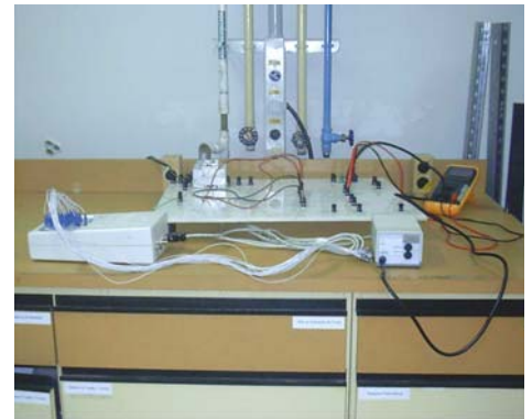
Foto 4 – Setup do ensaio de corrente de fuga
