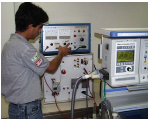
Foto 3 – Setup do ensaio de partes aplicadas a prova de desfibrilação
