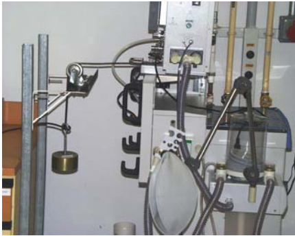
Foto 12 – Ensaio de tração em dispositivos de ancoragem de cabos
