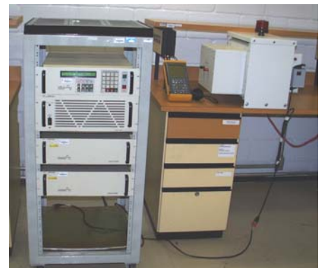
Foto 13 – Ensaio de rigidez dielétrica em trafos
